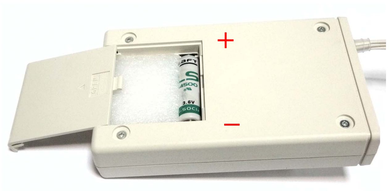
Рисунок 3 – Установка батареи в устройстве регистрации сигналов.
